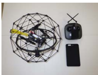
汎用小型球殻ドローンベース (外径40cm)
